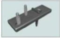
Le raccord de lame est fixé avec 2 vis sur la face inférieure de la lame et fixé avec une autre vis sur la sous-construction.
